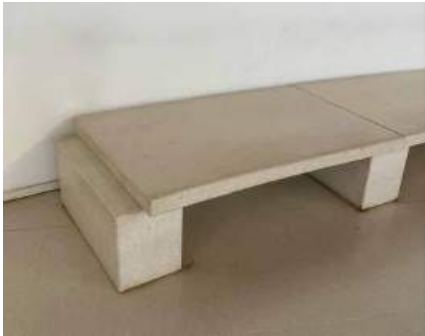
BANC Banc de llosa de formigó armat, de color gris granític, acabat decapat i hidrofugat, de 150 cm de llargària, amb suports de formigó col·locat recolzat sobre paviment
