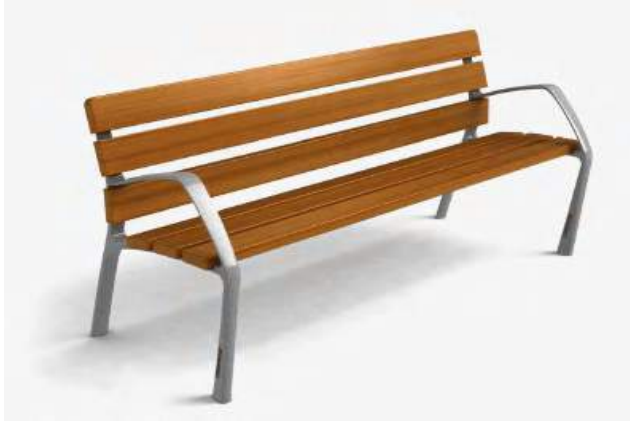
BANC Banc tipus Neobarcino de 180cm de llargada de Benito Urban SLU o equivalent formada per 6 taulons de 110x35 de fusta tropical tractada amb Lignus, protector fungicida, insecticida i hidròfuga, amb suports de fosa i cargols d'acer inoxidable. Inclòs daus de formigó
